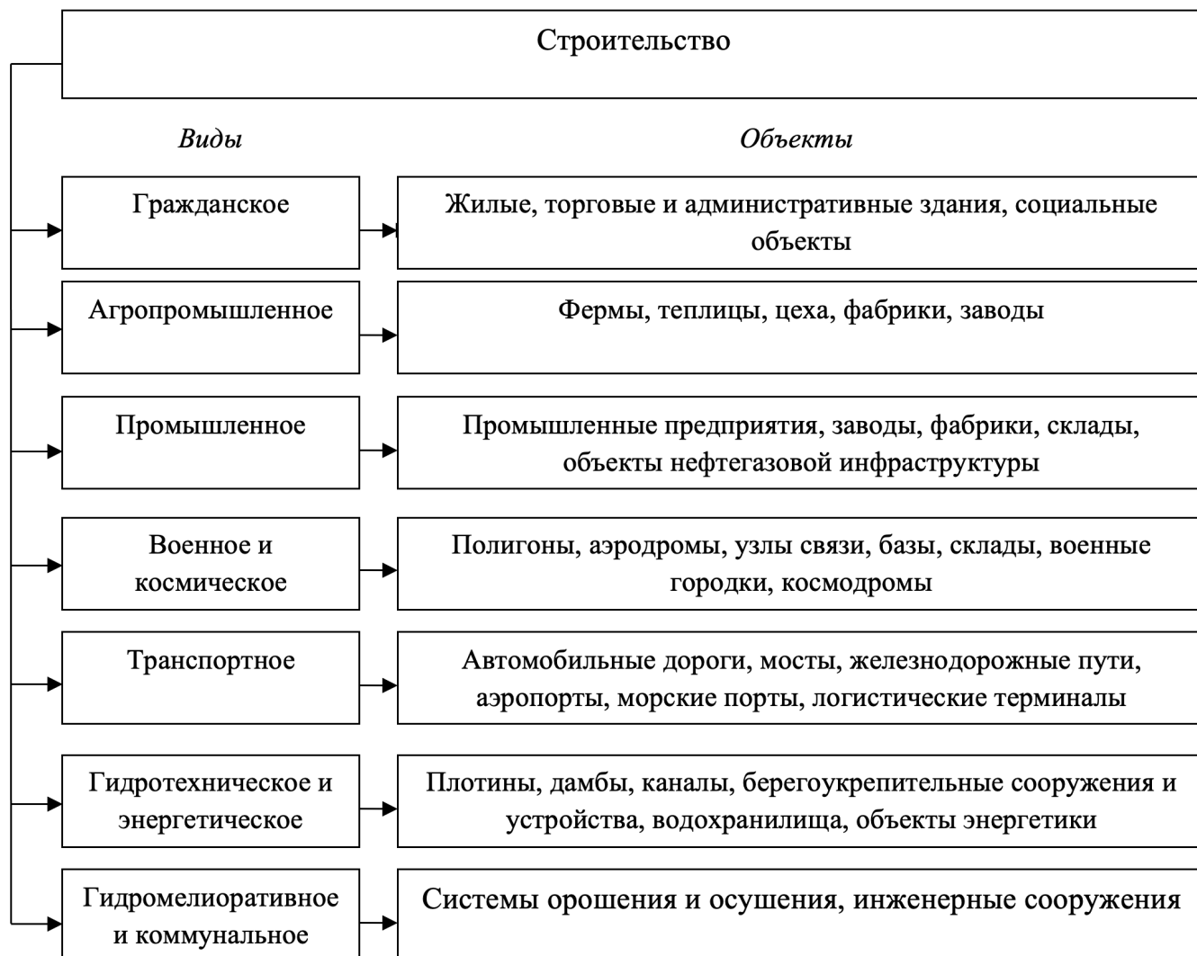
Рисунок 2 – Классификация видов строительства и объектов возведения в РФ
